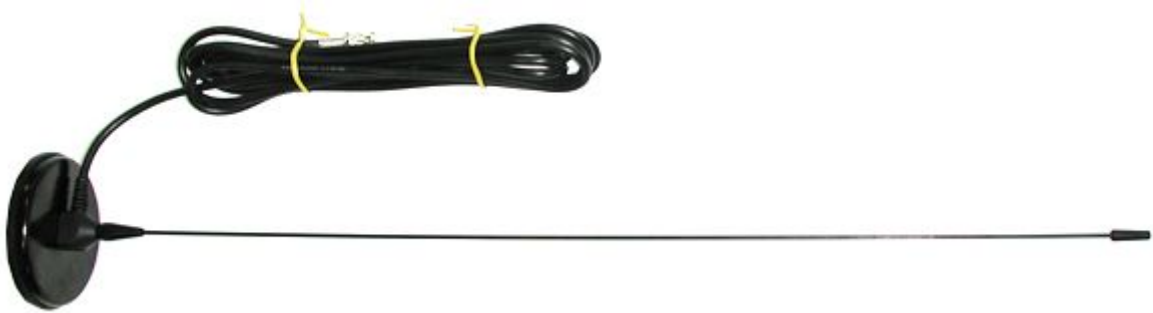
UT-308UV Frequency : 144 / 430 MHz Gain : 3.0 dB Magnet Size : 80 mm Antenna Length : 562 mm Cable : RG-58 / RG-174 Connector : BNC, SMA
