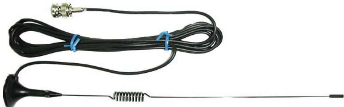
UT-102UV Frequency : 144 / 430 MHz Gain : 2.15 dB Magnet Size : 31 mm Antenna Length : 300 mm Cable : RG-174 Connector : BNC, SMA
