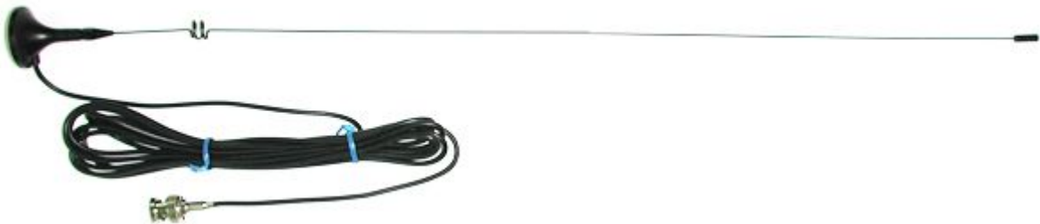
UT-108UV Frequency : 144 / 430 MHz Gain : 3.0 dB Magnet Size : 31 mm Antenna Length : 510 mm Cable : RG-174 Connector : BNC, SMA
