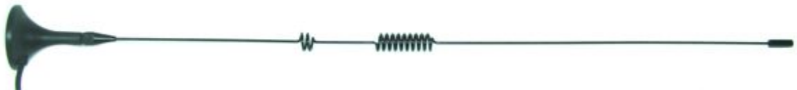
UT-106UV Frequency : 144 / 430 MHz Gain : 3.0 dB Magnet Size : 31 mm Antenna Length : 390 mm Cable : RG-174 Connector : BNC, SMA
